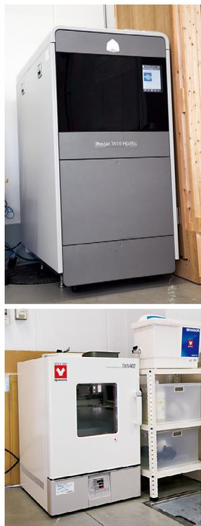
3Dプリンター「ProJet 3510HD Plus」は、出力精度の高さだけでなく、サポート材の後処理が手軽な点も大きな魅力だ
